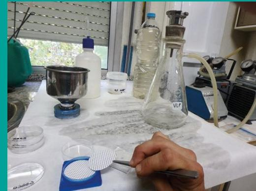
2º- Vertemos una pequeña cantidad de agua de la muestra en el embudo del equipo de filtración.
