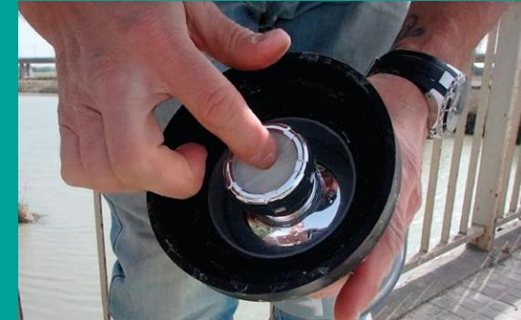
4º- Volcaremos la muestra de agua recogida sobre el filtro, primero poco a poco y después adaptándolo al ritmo del flujo filtrado.
