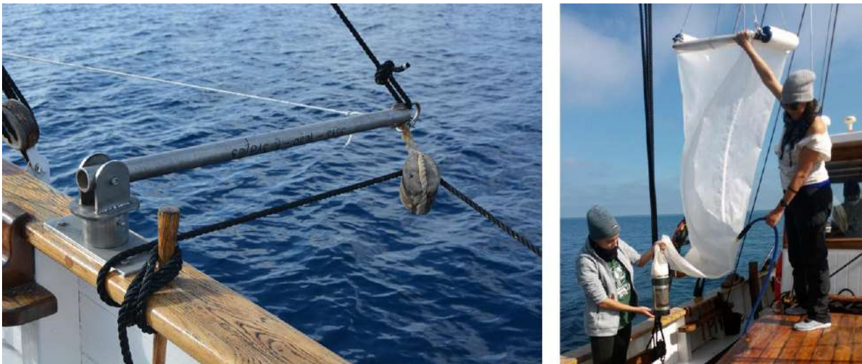
Figura 48. Izquierda: tangón lateral instalado en el Else para soportar el arrastre de la red de muestreo. Derecha: limpieza de la red y recogida de la muestra en el colector con ayuda de la bomba de agua marina a presión.
