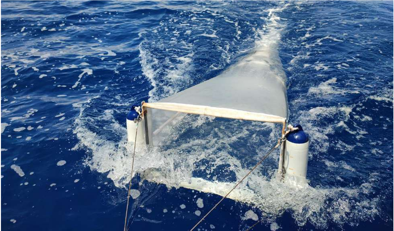
Figura 49. Red de muestreo tipo Neuston para muestreo superficial.
