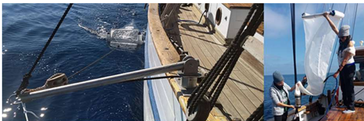
Figura 62. Tangón instalado en la banda de estribor del Else para el arrastre de la red Neuston (izda.). Limpieza y trasvase de la muestra al colector utilizando la manguera de agua marina a presión (dcha.).
