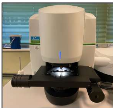
Imagen 32: Microscopio infrarrojo Spotlight 200i de Perkin Elmer
