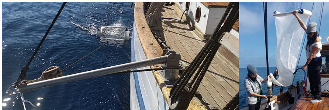
Figura 24: Tangón instalado en la banda de estribor del Else para el arrastre de la red Neuston (izda.). Limpieza y trasvase de la muestra al colector utilizando la manguera de agua marina a presión (dcha.).
